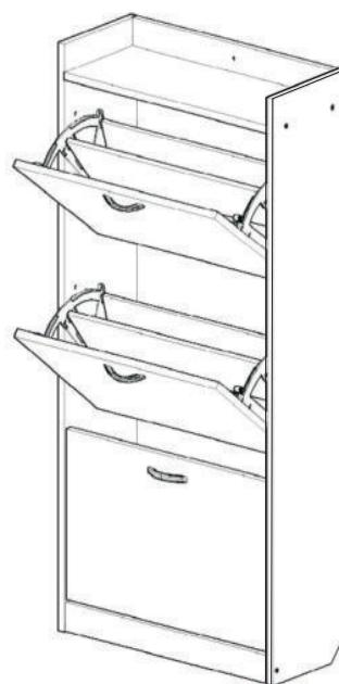
8 После окончательной сборки изделия во всех видимых местах в головку конфирматы №51 установить заглушку конфирмата №52. Обязательно закрепите шкаф к стене при помощи уголка на детали №3, дюбеля №8 и самореза №64.
