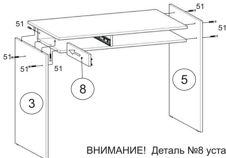
**ВНИМАНИЕ!** Деталь №8 устанавливается в последнюю очередь, после затяжки эксцентрика.
