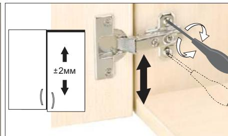
Слегка ослабить крепежные винты ответной планки. Выровнять по высоте позицию двери. Затем крепежные винты снова затянуть.
