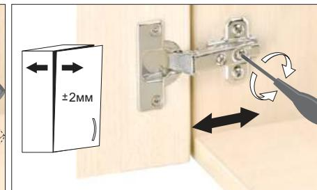
Ослабить крепежный винт и отрегулировать расстояние между дверью и боковой панелью шкафа. Затем снова затянуть крепежный винт.
