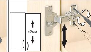
Слегка ослабить крепежные винты ответной планки. Выровнять по высоте позицию двери. Затем крепежные винты снова затянуть.
