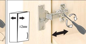
Ослабить крепежный винт и отрегулировать расстояние между дверью и боковой панелью шкафа. Затем снова затянуть крепежный винт.
