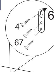
Перед установкой з.стенок выровнять диагональ корпуса.
