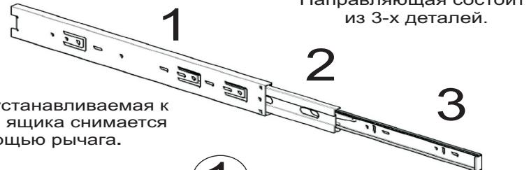
Деталь устанавливаемая к боковине ящика снимается с помощью рычага.
