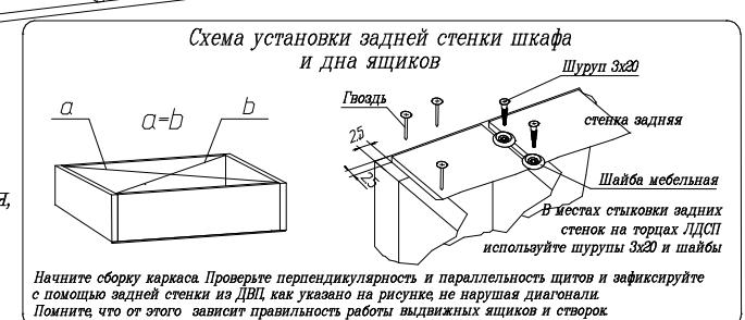
Начните сборку каркаса. Проверьте перпендикулярность и параллельность щитов и зафиксируйте с помощью задней стенки из ДВП как указано на рисунке не нарушая диагонали. Помните, что от этого зависит правильность работы выдвижных ящиков и створок.
