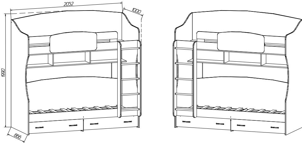
Допускается Вариант зеркальной сборки
